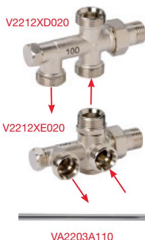
Distributeur 4 voies + tube chromé - Raccordement Euroconus 3/4" - Laiton nickelé mat - Pression statique max. 10 Bar - Température max. 130°C - Entraxe 38mm
