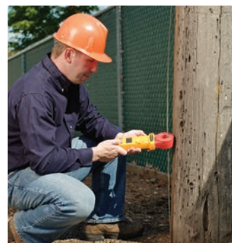
ES-162P3 elektrode-/haspelset voor 3-polige metingen voor 1621
