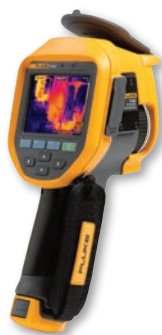
MultiSharp™ Focus geeft een beeld dat is scherpgesteld op elke afstand.
