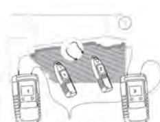
LOKALISEREN VAN EEN BREUK OP EEN VERWARMINGSKABEL
