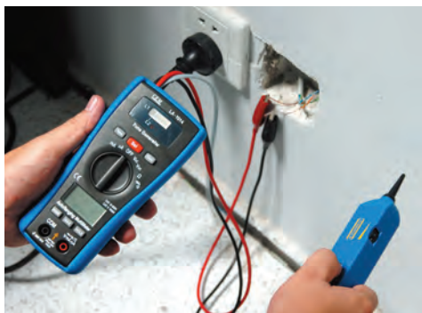
Test zonder bijstand uw geleiders in de kast door simpelweg de krokodillenklampen op de geleiders aan te sluiten.
