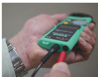
Standaard-ingangsklemmen (4mm) voor normale meetsnoeren
