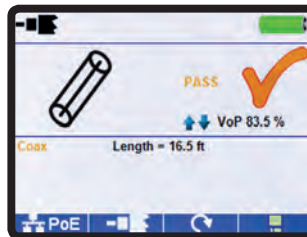
Meet de lengte van de kabels en de afstand tot een fout met de Time Domain Reflectometry (TDR) technologie
