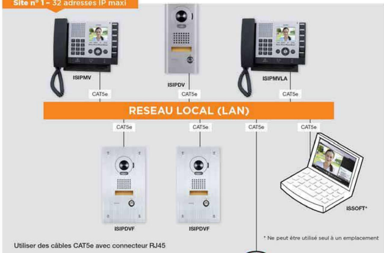
Utiliser des câbles CAT5e avec connecteur RJ45
