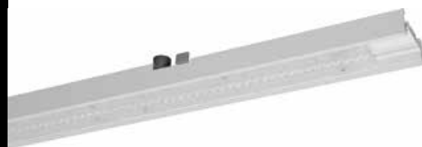
module 77W / 4000K / niet dimbaar / 80° / 9820lm / 1480cm DIRTRXLED1480SW73684
