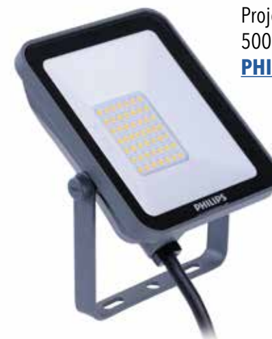
Projector 50W / 3000K / niet dimbaar / 5000lm / L 249 B 235 H 38 + beweging PHI33135599
